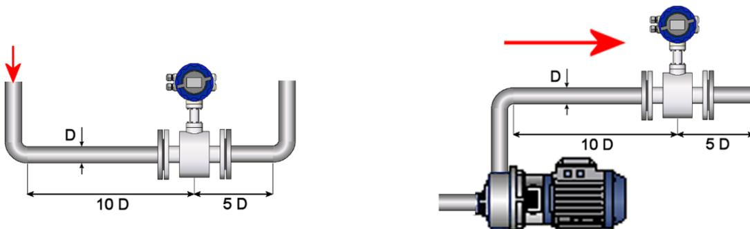
**Bombas:** Sin embargo, cuando se instala una bomba en línea, habría que aumentar a 15 diámetros la distancia antes del caudalímetro
