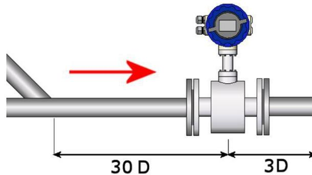
**Uniones con la tubería:** Las uniones del caudalímetro con las tuberías son puntos críticos donde se pueden producir turbulencias, que afecten a la precisión de los equipos, si no realizan de forma adecuada.
