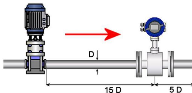
**Válvulas:** Las válvulas manuales hay que ponerlas detrás del caudalímetro. Si se quisieran poner delante del mismo, hay que aumentar el tramo recto hasta 30 D. Esto es debido a que, si se deja una válvula a medio abrir, se altera mucho el flujo laminar del líquido
