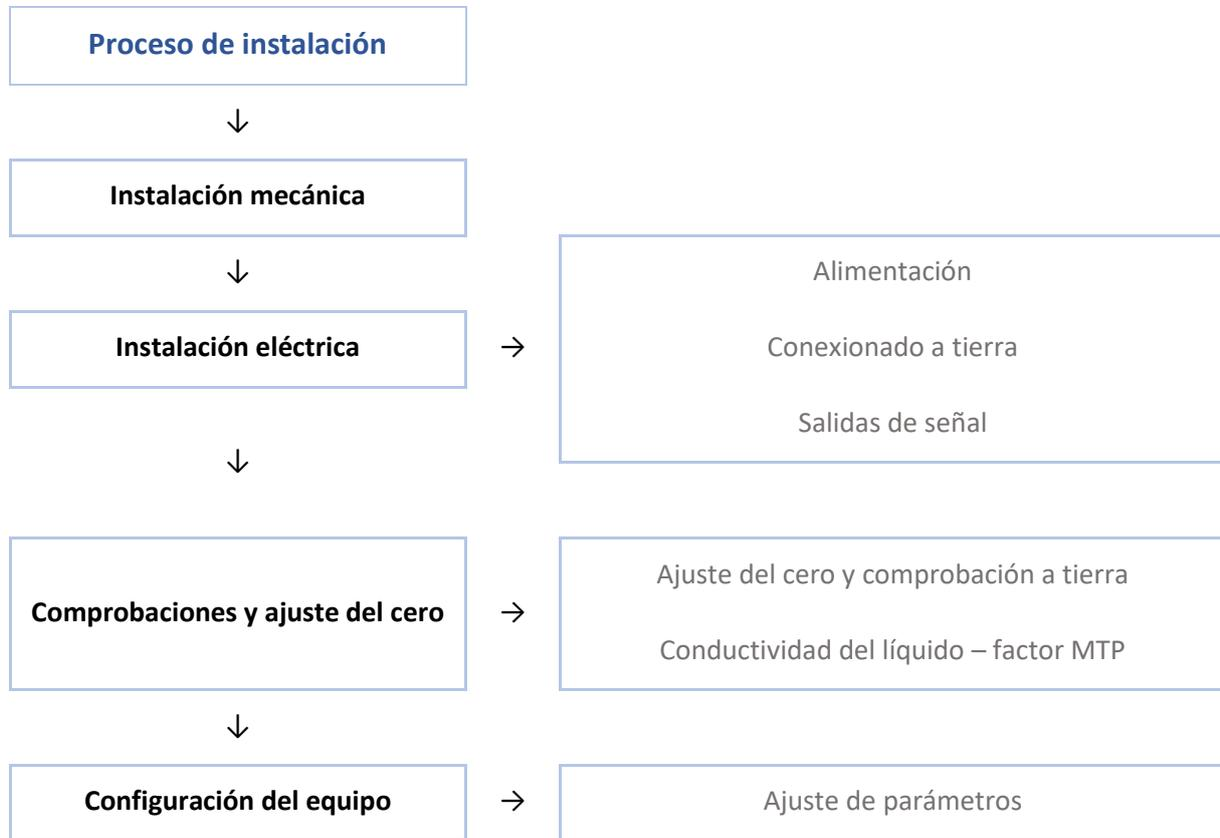
Todos los pasos son importantes para que el caudalímetro electromagnético mida con precisión, pero hay que destacar por su importancia **la Instalación Mecánica y el conexionado a tierra** del equipo y su **comprobación**
