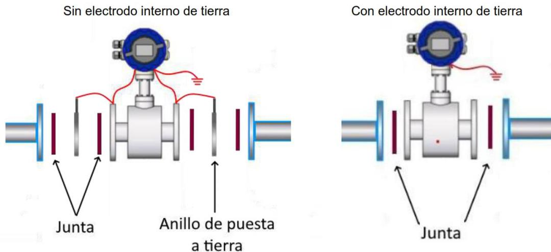
La conexión a tierra de los equipos debe realizarse con cable de cobre de sección mayor o igual a 4 mm<sup>2</sup> y la resistencia de tierra debe ser inferior a 10Ω.
