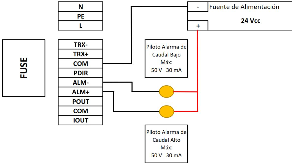
**Conexionado de las salidas de alarmas con Relés**
