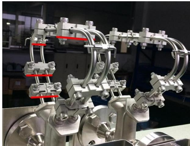
El caudalímetro másico Coriolis de doble tubo está formado por dos tubos de medición, una bobina excitadora de los tubos y dos sensores electromagnéticos A y B.
